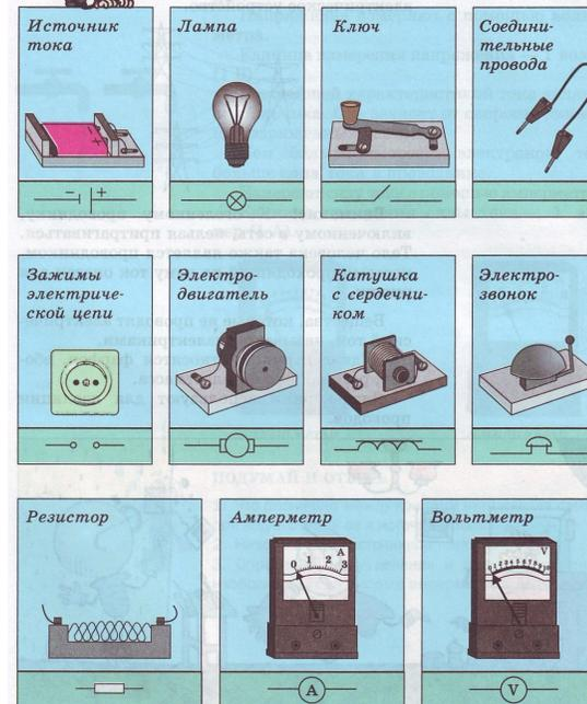
4.2. Изучите пример. Справа дан рисунок электрической цепи, а слева - этот рисунок превращен в схему с помощью условных обозначений цепи.
