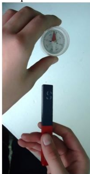
Б) Магнитное поле постоянного прямого магнита
